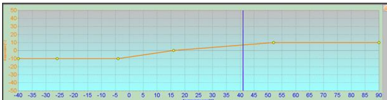
Рис. 16 Вид карты коррекции от температуры газа
